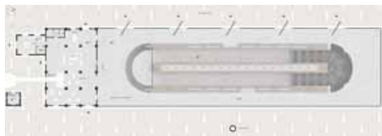
15/16 - La fornace Croce nel parco delle Groane: pianta del forno Hofmann e l'assonometria del nuovo elemento di innesto che va a riprodurre una delle teste "mozzate" del forno.
